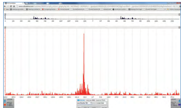
Sin correlación en línea de datos acústicos de un registrador de ruido de red SebaLog N-3
